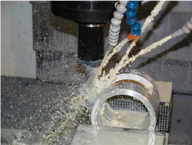
腐蚀性保护。近年来聚合酯在铝加工液中的使用较多,在铝切削加工中表现出良好的润滑性能。加上其他材料的助洗和分散能力,使用水基切削液产品完全可以解决铝合金切削润滑问题。比如发动机油口的凸轮轴孔和阀座导管孔及活塞的回油环的外圆车削和回油孔的精膛。铝合金切削液另一难题是其腐蚀性。市场
